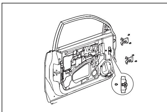
1. 拆卸左前侧面车门总成
